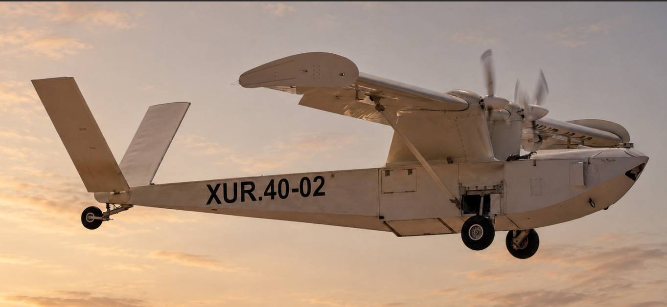
Figura 1. Flyox I en vuelo — perfil lateral que muestra el diseño de ala alta en voladizo y el tren de aterrizaje retráctil.
